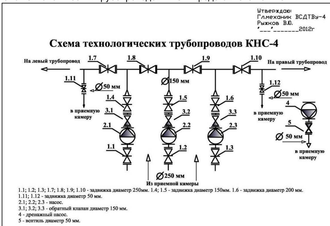
Рис. 1.17. Схема технологических трубопроводов КНС-4
