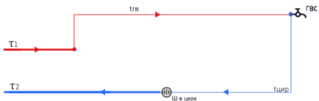
Рис. 1.21. Схема присоединения системы горячего водоснабжения потребителей по четырехтрубной схеме теплоснабжения.
