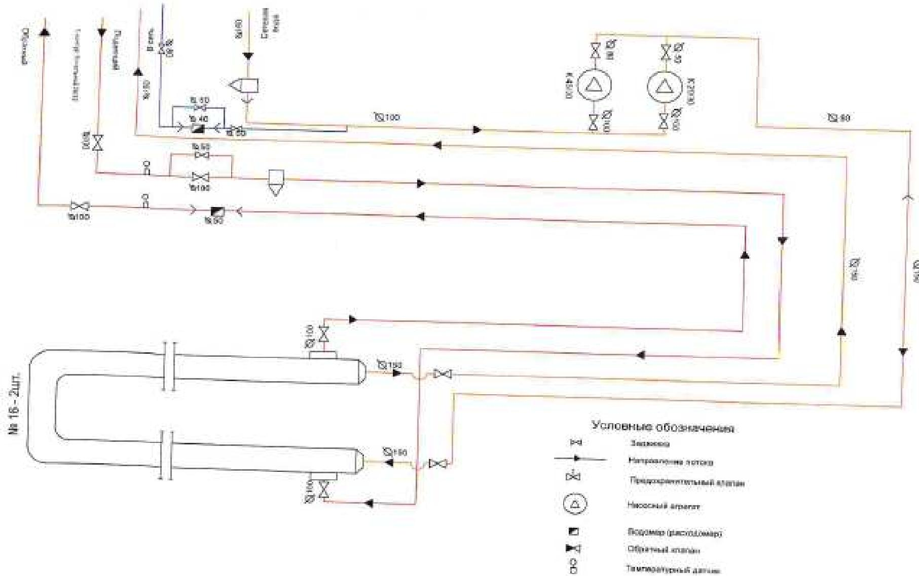
Рис. 1.11. Термомеханическая схема ЦТП-13
