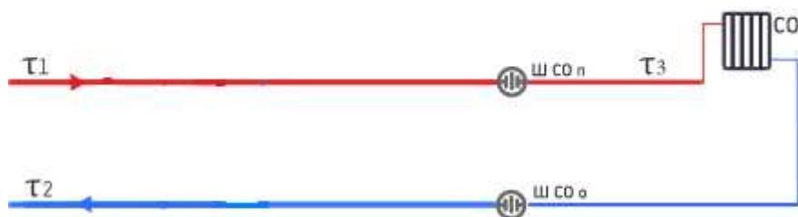
**Рис. 1.19. Непосредственное присоединение системы отопления к тепловым сетям**
