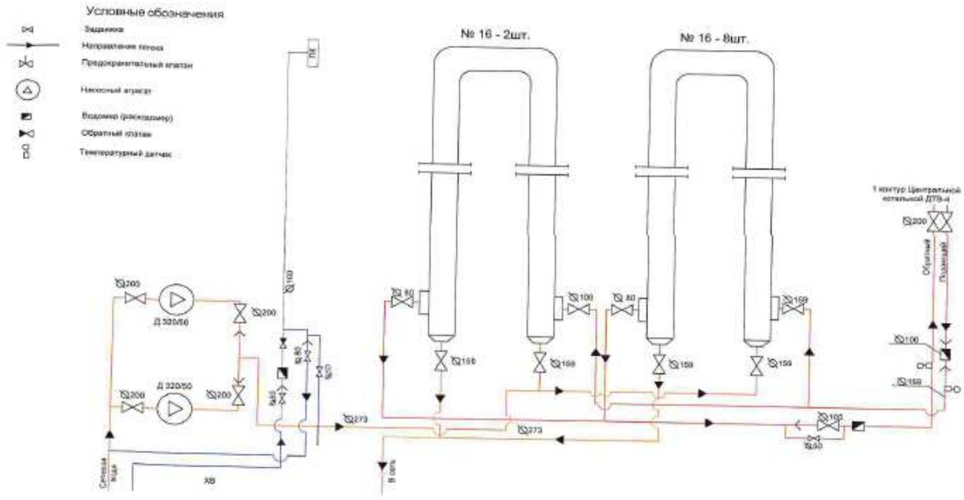
Рис. 1.2. Тепломеханическая схема ЦТП-2
