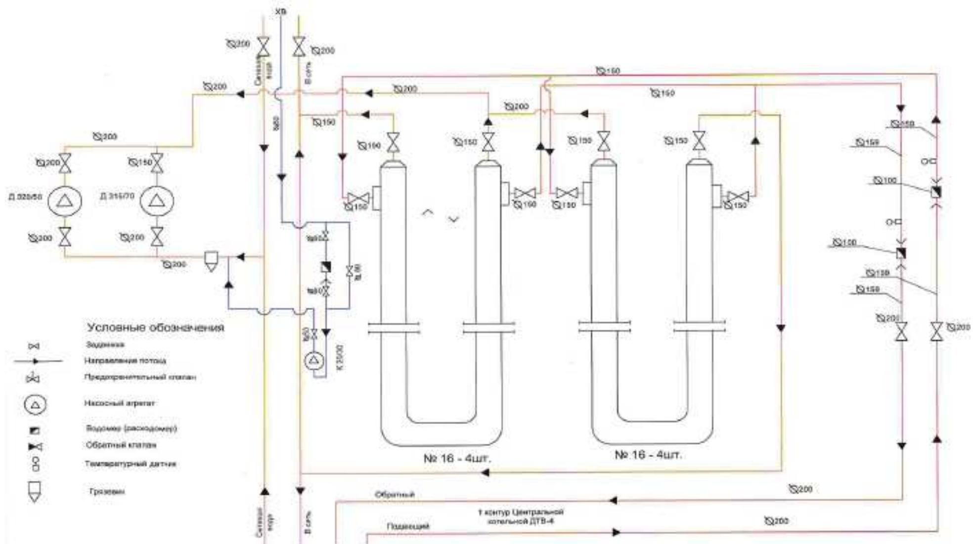
Рис. 1.1. Термомеханическая схема ЦТП-1
