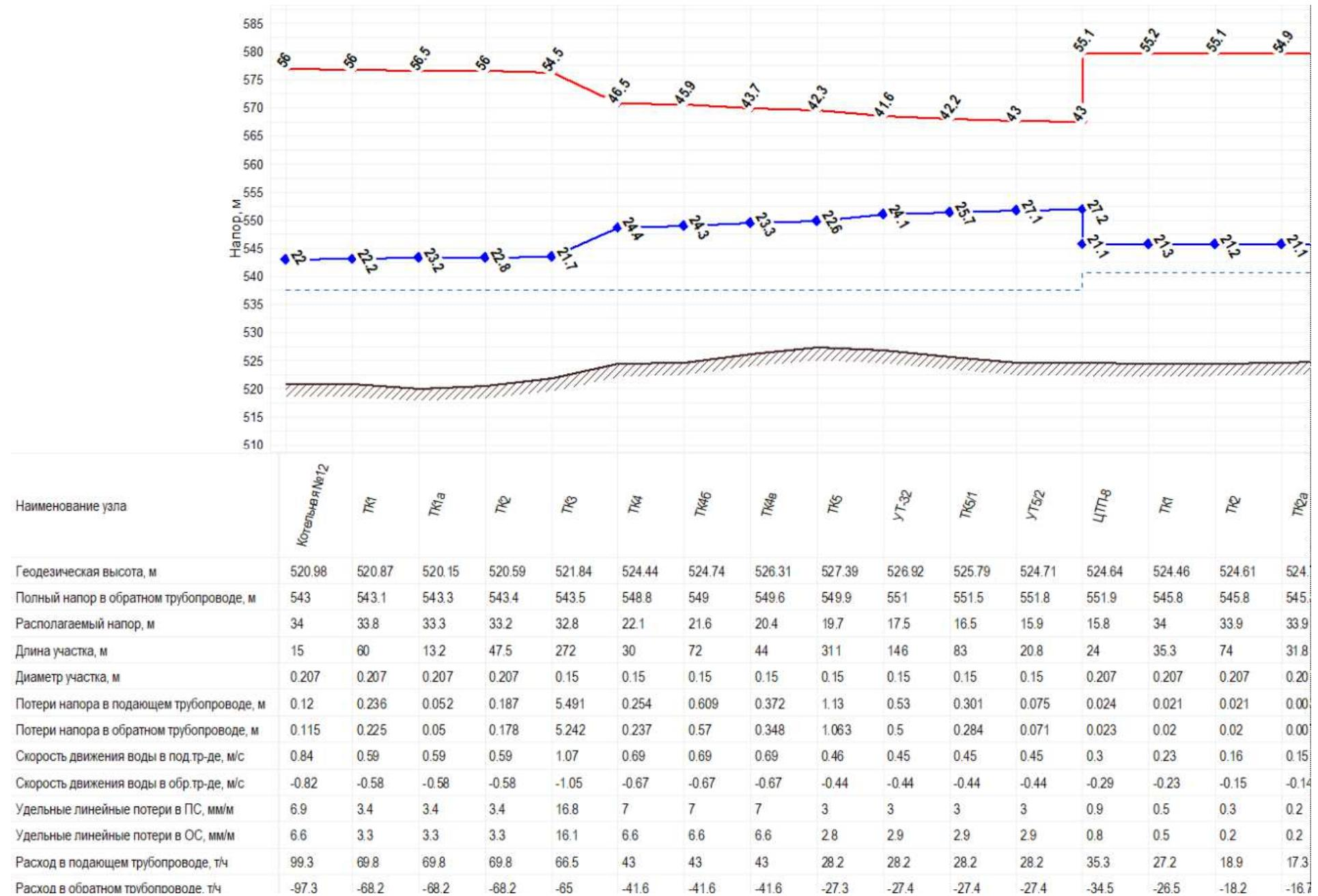
Рис. 3.18. Существующий пьезометрический график от Котельной №12 до ул. Рабочая, 37а (начало)
