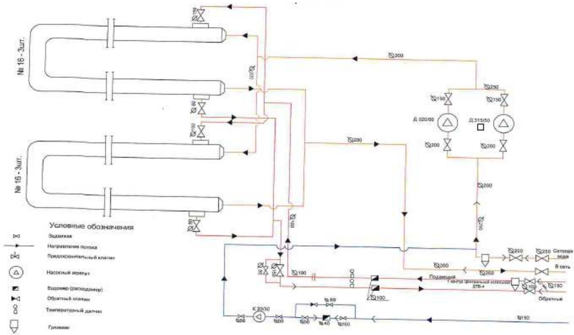
Рис. 1.3. Тепломеханическая схема ЦТП-3
