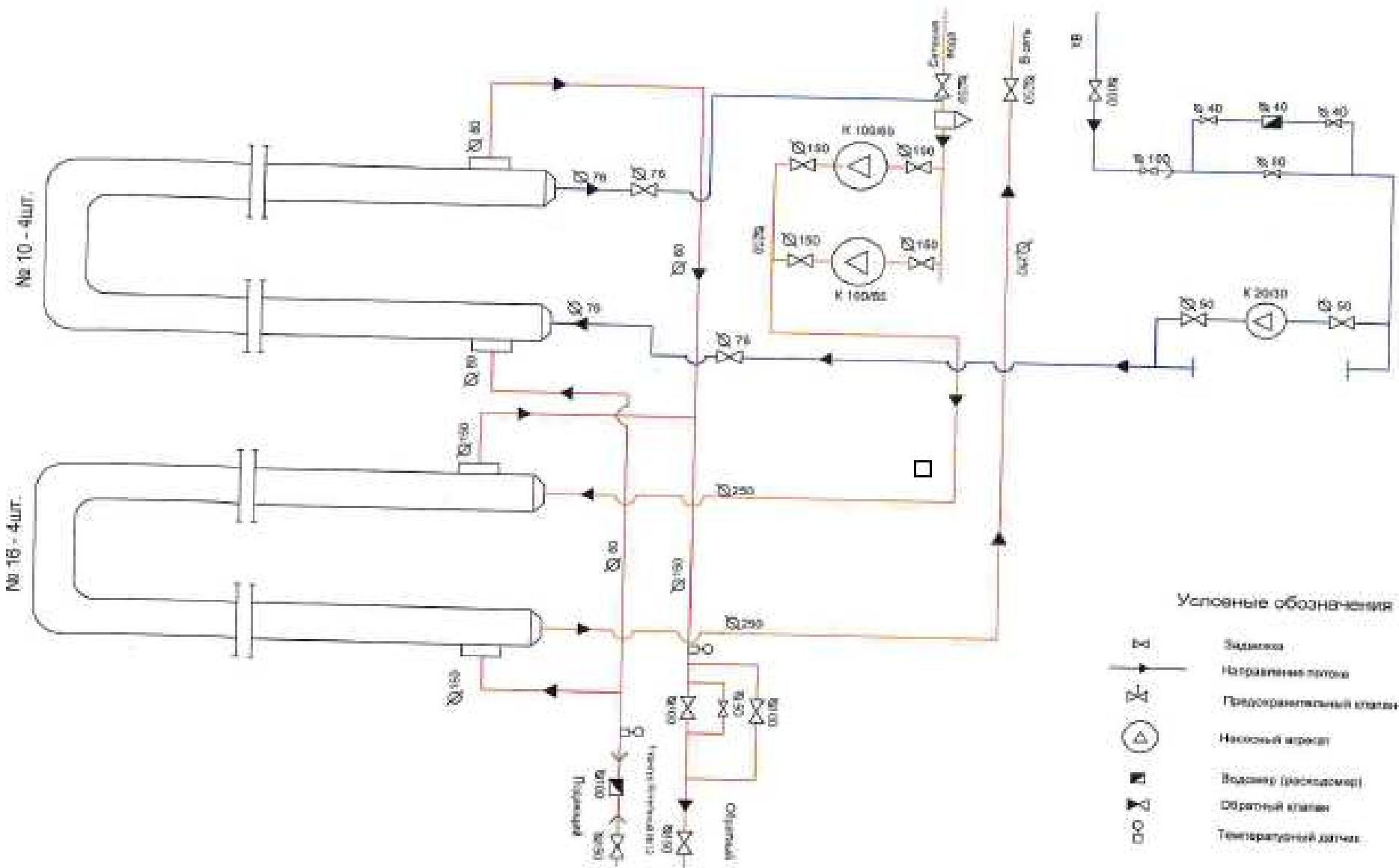
Рис. 1.6. Термомеханическая схема ЦТП-6
