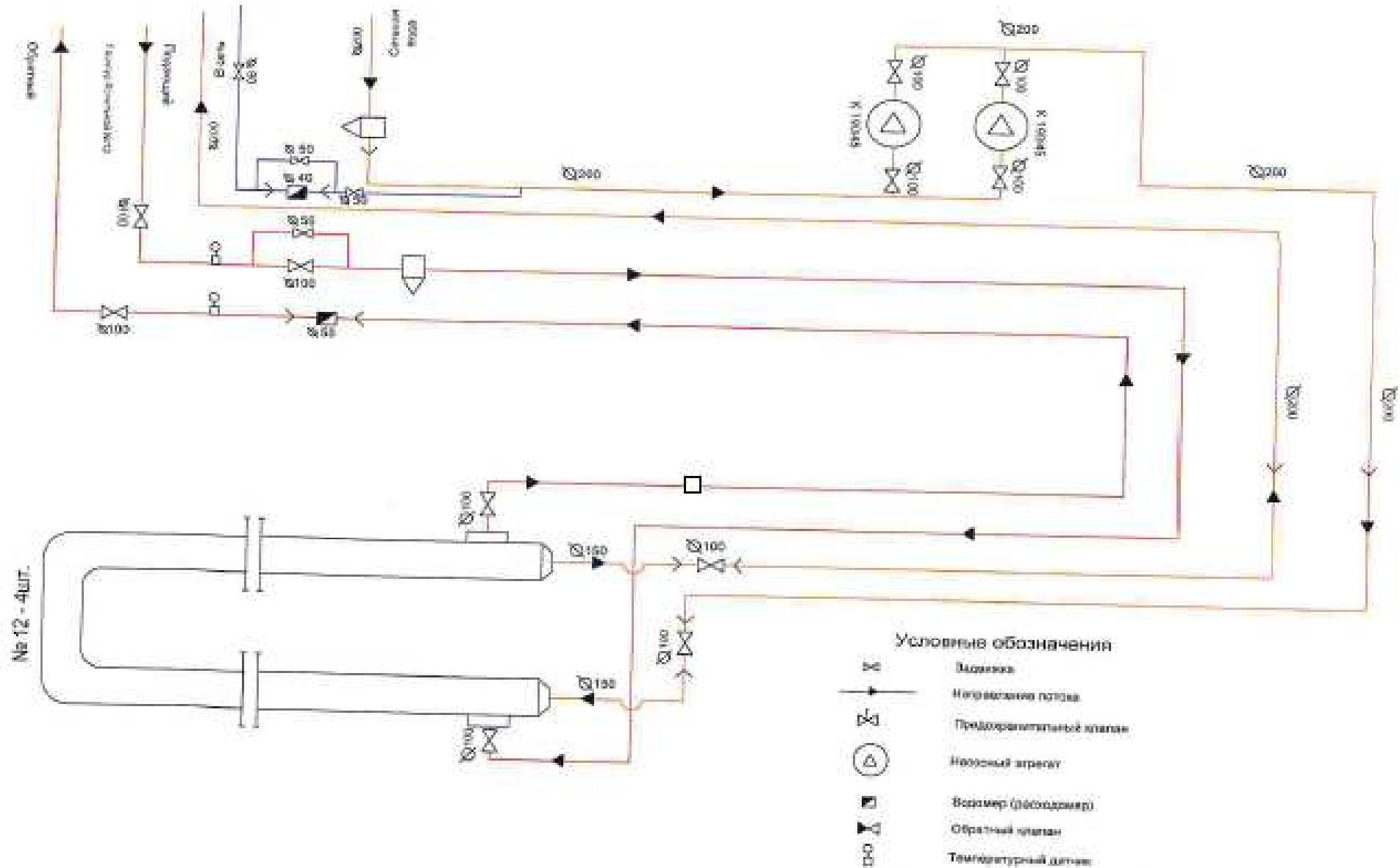
Рис. 1.7. Термомеханическая схема ЦТП-7
