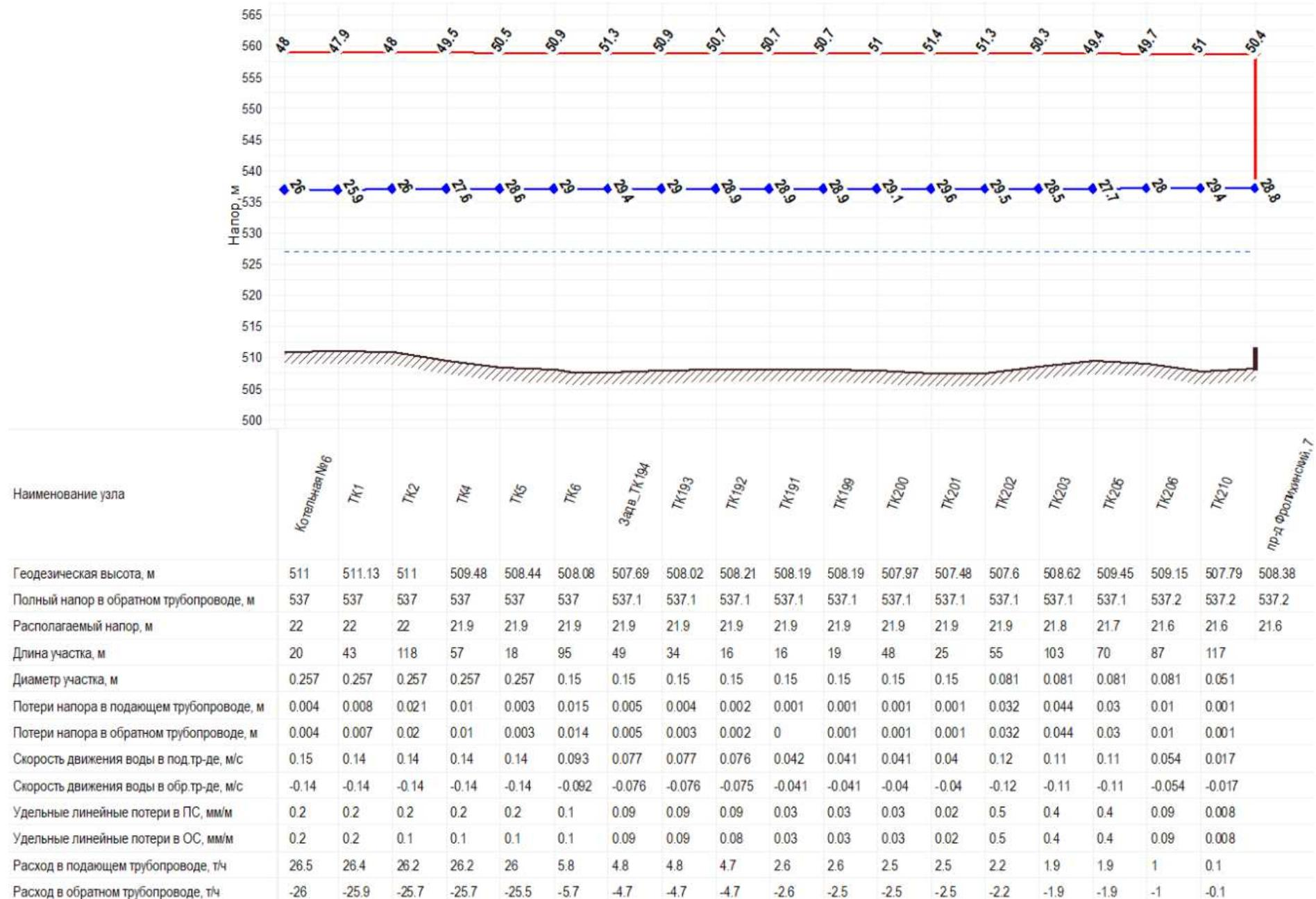
Рис. 3.15. Существующий пьезометрический график от Котельной №6 до пр-д Фролихинский, 7
