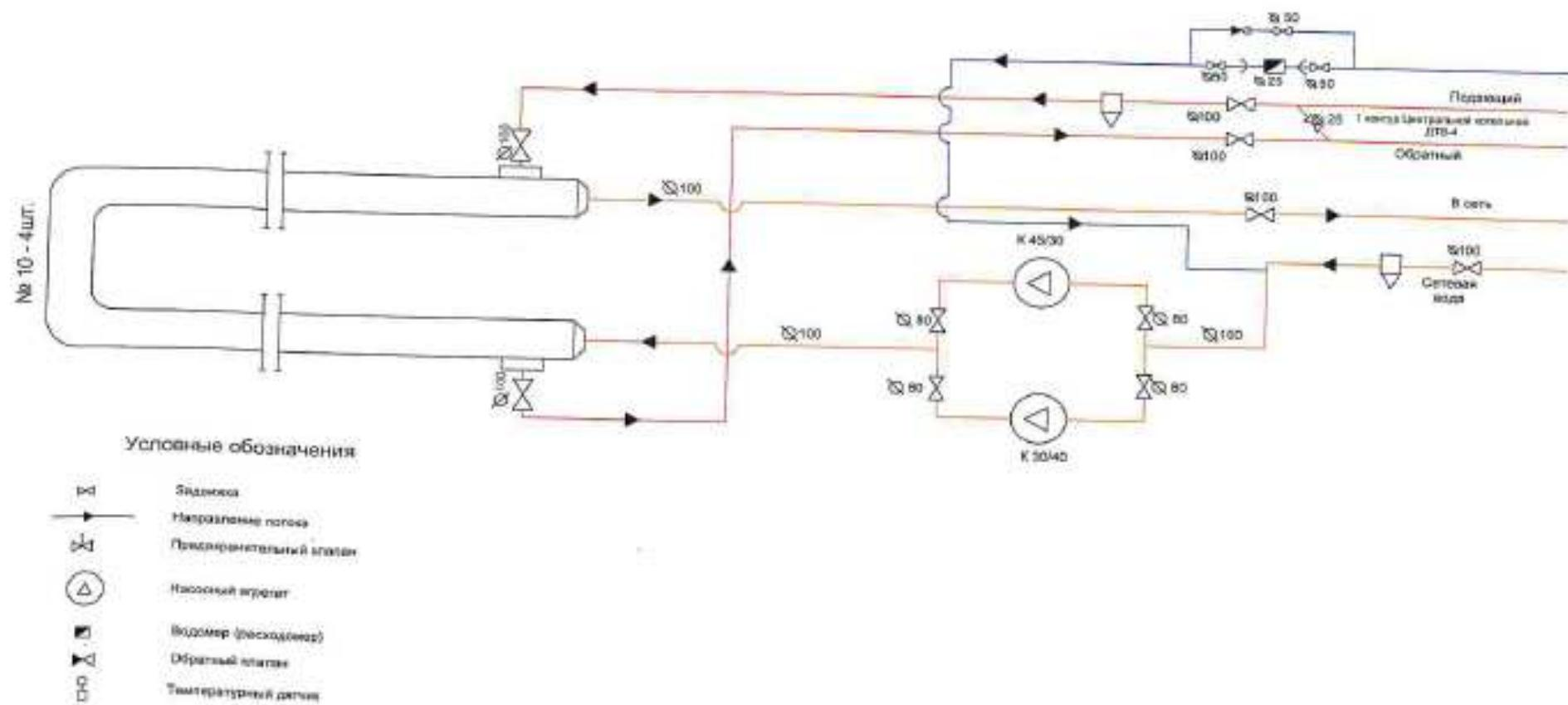
Рис. 1.10. Термомеханическая схема ЦТП-10
