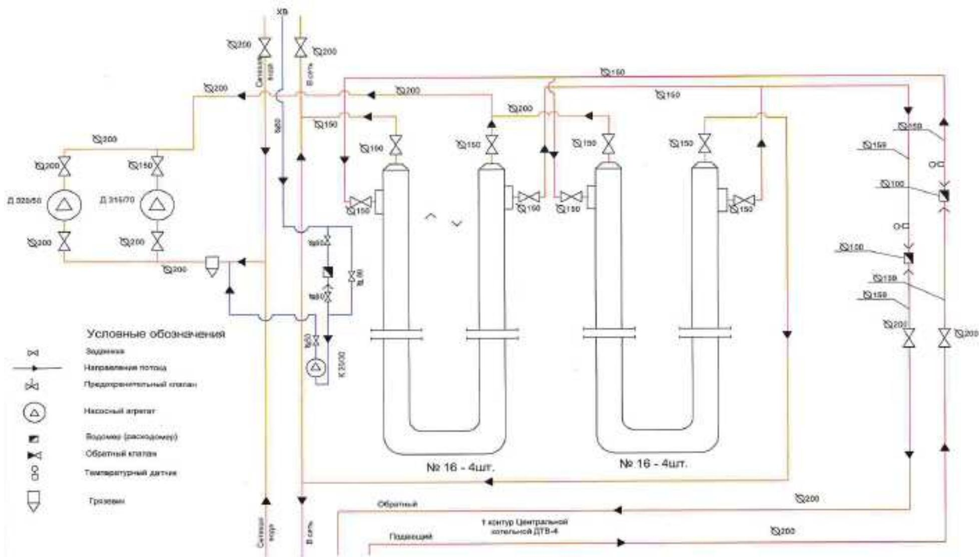
Рис. 1.1. Тепломеханическая схема ЦТП-1
