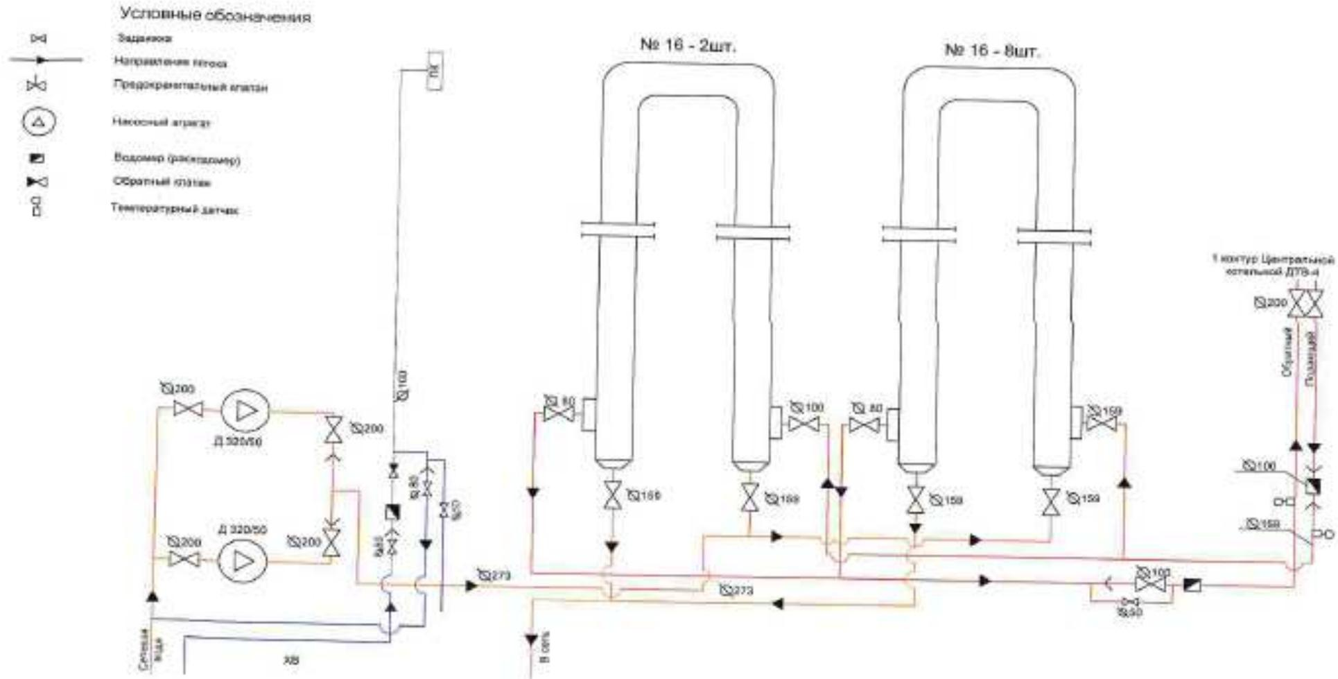
Рис. 1.2. Термомеханическая схема ЦТП-2
