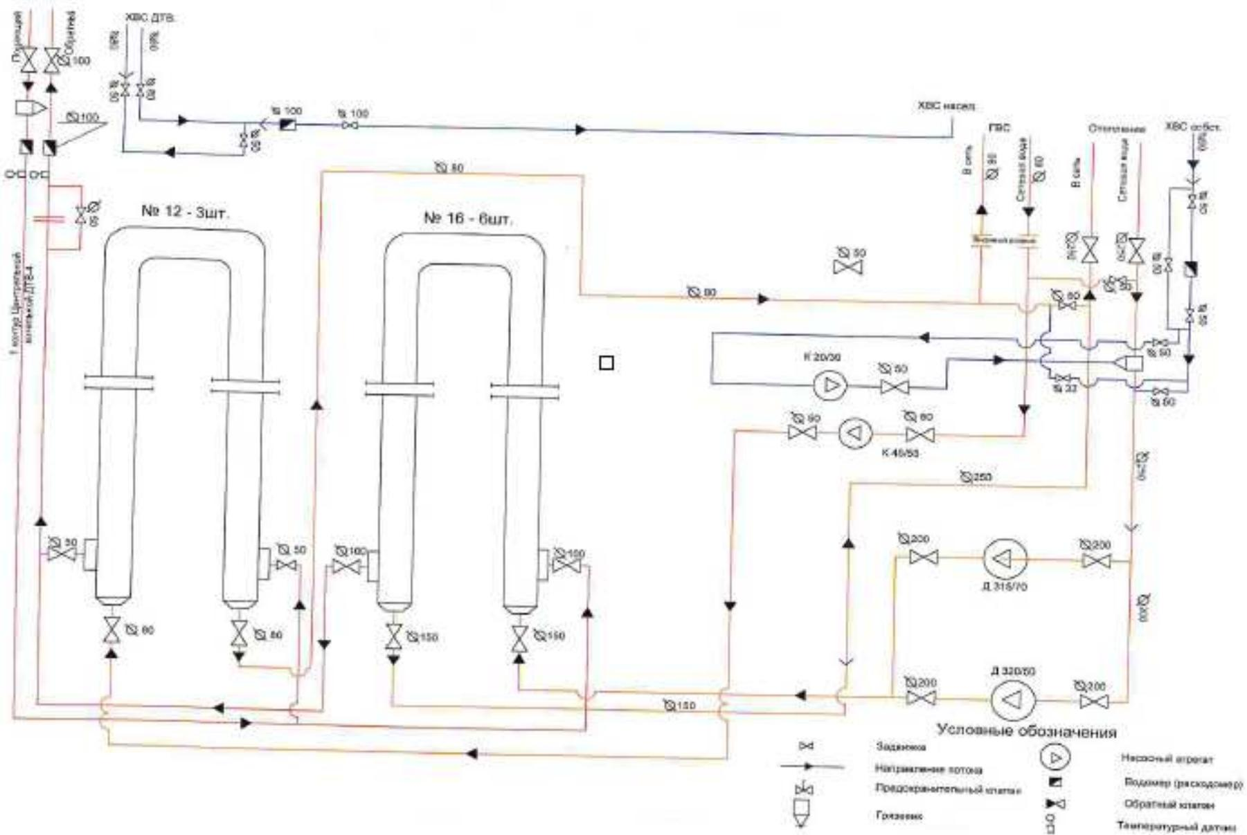
Рис. 1.4. Термомеханическая схема ЦТП-4
