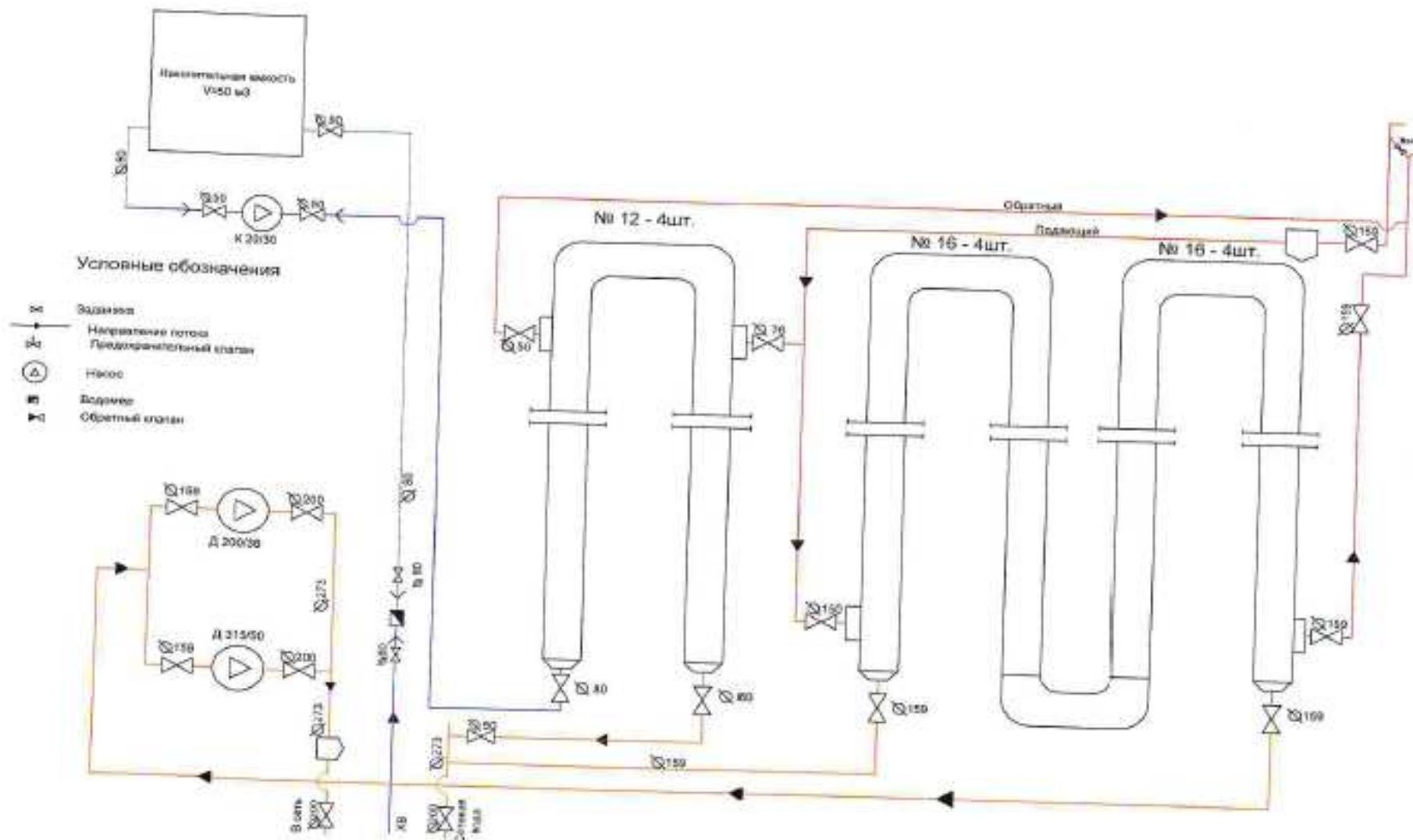
Рис. 1.12. Термомеханическая схема ЦТП-15
