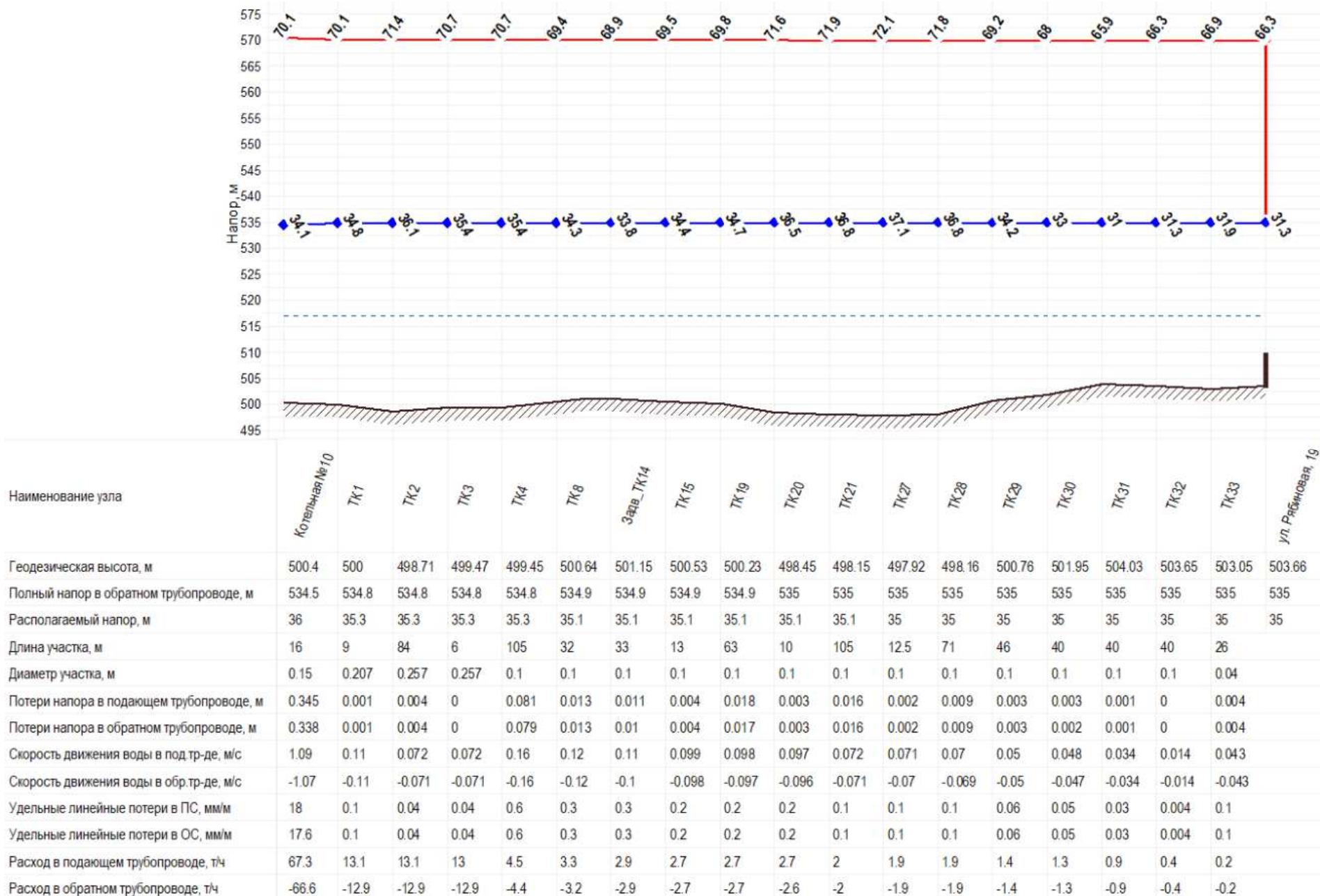
Рис. 3.12. Существующий пьезометрический график от Котельной №10 до ул. Рябиновая, 19
