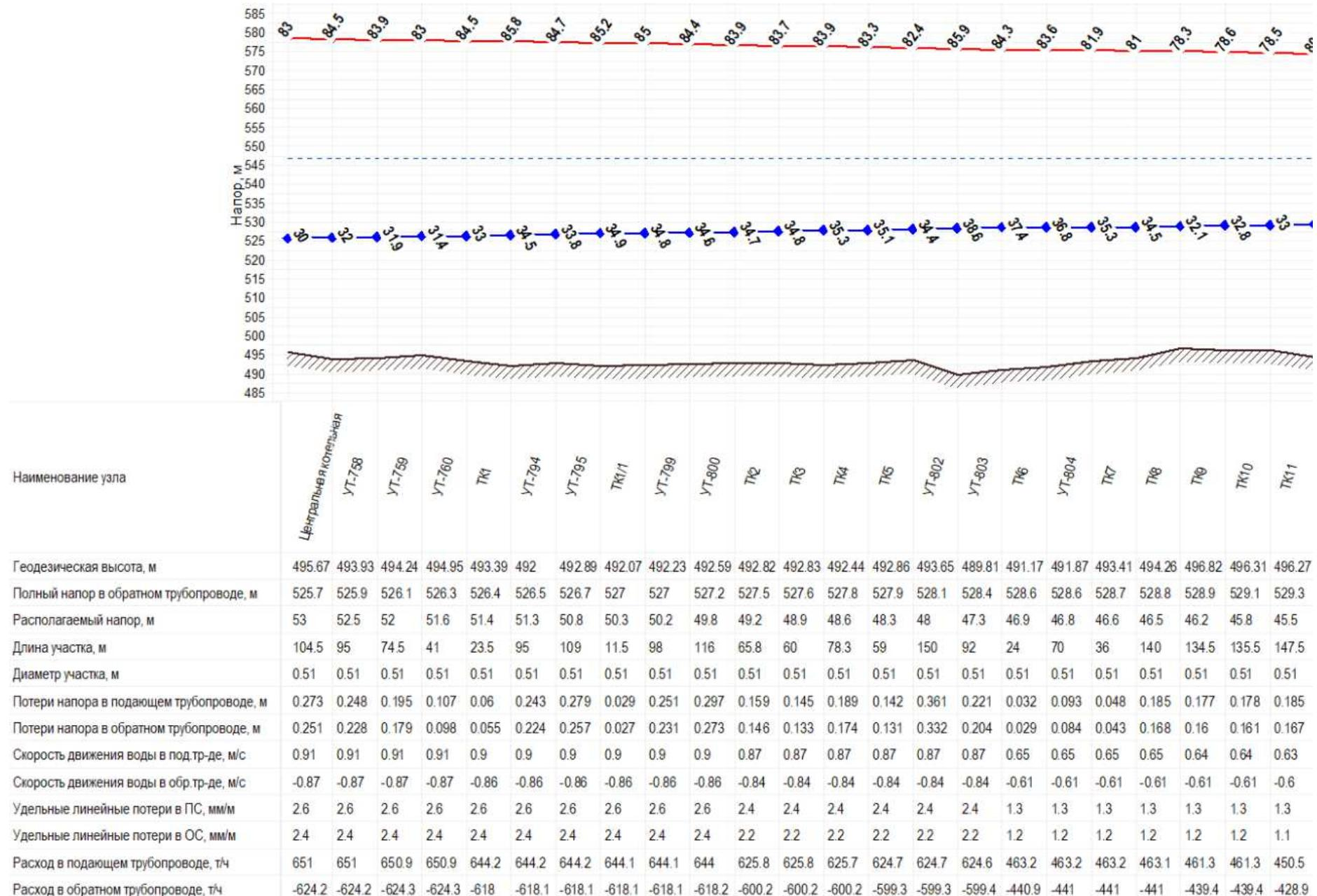
Рис. 3.2. Существующий пьезометрический график от Центральной котельной до ул. Ленина, 10 (начало)
