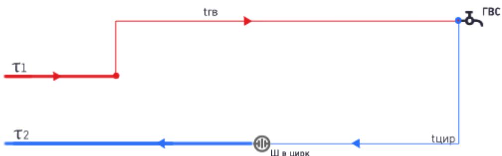
Рис. 1.24. Схема присоединения системы горячего водоснабжения потребителей по четырехтрубной схеме теплоснабжения.
