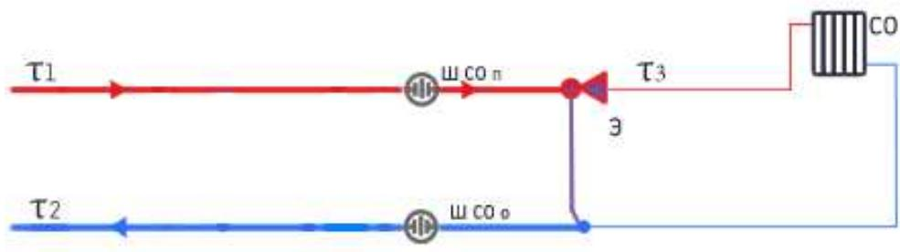
Рис. 1.20. Зависимое присоединение системы отопления через элеваторный узел
